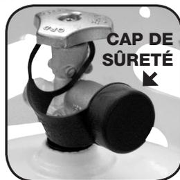
1. le déconnecter. Installer le bouchon de sécurité sur la soupape. Utilisez toujours le bouchon et sangle fournis avec la soupape. Le manque d'utiliser le bouchon de sécurité selon les consignes peut entraîner en blessures sérieuses ou dommages matériels.
